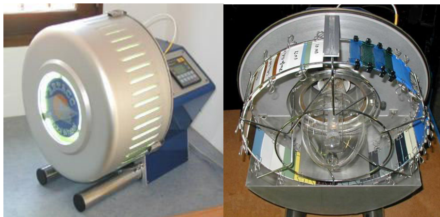
Figure 2-11: Enceinte de photo-vieillissement ARTACC® ( http://www.stationdebandol.com )
