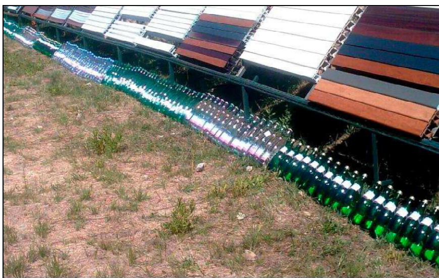
Figure 4-2: Exposition solaire des bouteilles des marques A et B en PET et verre à la station de vieillissement naturel de Bandol (83)
