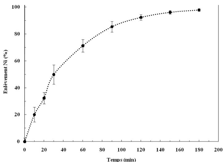
**Figure 4.6** Électroplaquage du Ni à partir de la solution aqueuse de contre extraction en fonction du temps. Conditions initiales:  $[pH]_i = 2$ ,  $[Ni]_i = 131 \pm 3$  mg/L,  $[Mg]_i = 87.0 \pm 3.2$  mg/L,  $[Fe]_i = 0.38 \pm 0.23$  mg/L, densité de courant =  $330$  A/m<sup>2</sup>, Voltage = 3 V
