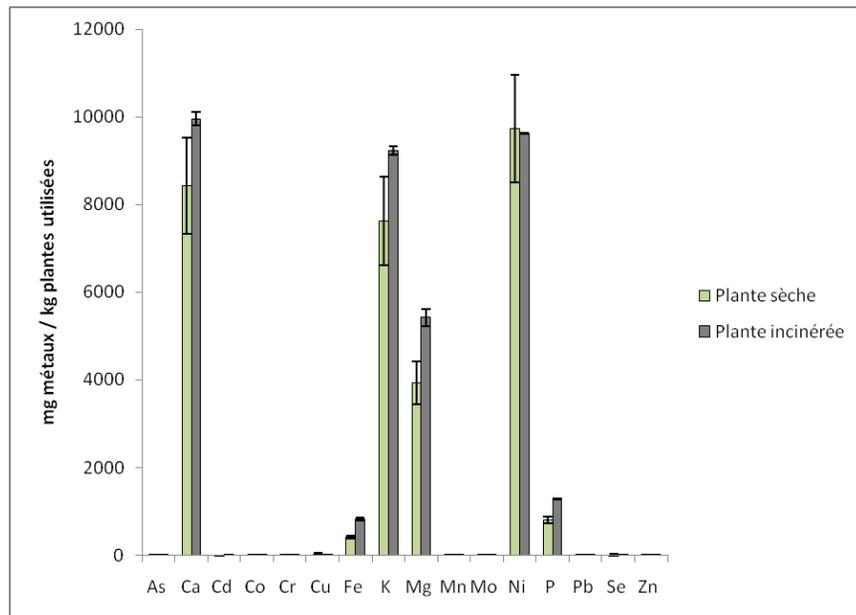
**Figure 5.1** Bilan de masse de l'incinération de 1.0 kg de MS de la plante *A. murale*
