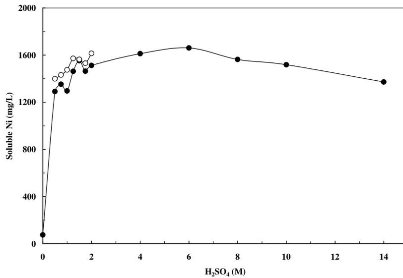
**Figure 3.2** Effet de la concentration d'acide sulfurique sur la solubilisation du Ni des graine de *A. murale*.  $t = 120$  min,  $[ST] = 150$  g/L,  $T = 90$  °C. Symboles: (●) Sans  $H_2O_2$ , (○) Avec 4 g  $H_2O_2/L$
