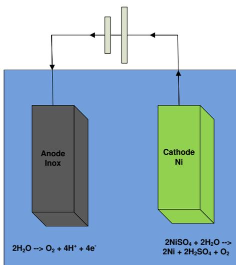
**Figure 1.13** Electrodeposition du Ni
