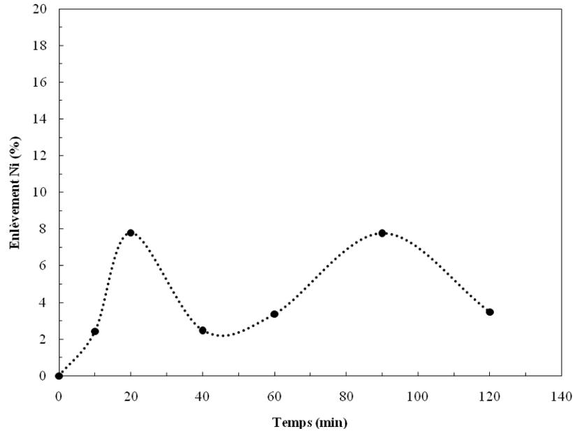
**Figure 4.2** Taux d'enlèvement du Ni à partir du lixiviat de *A. murale* par électrodéposition.
