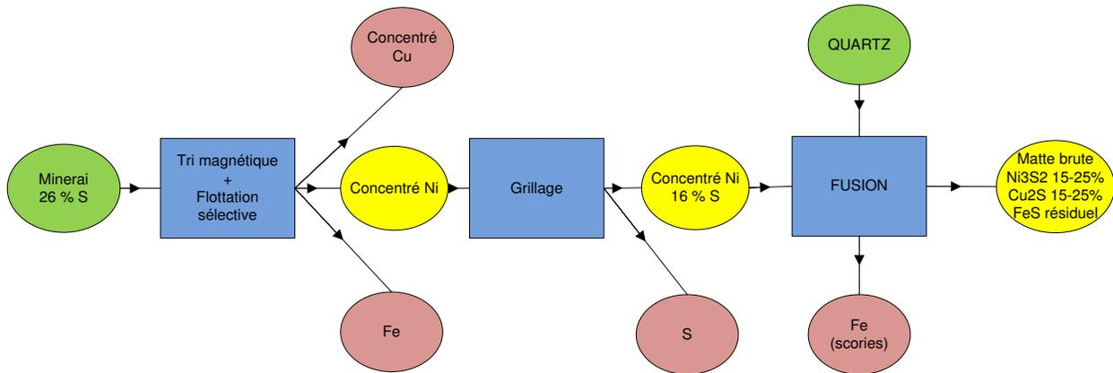
**Figure 1.3** Traitement du minerai sulfuré en matte brute
