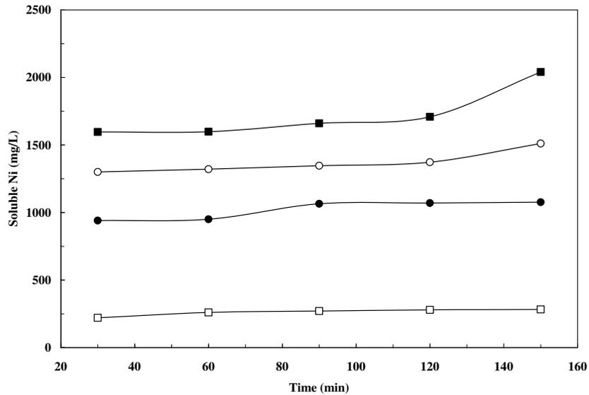
**Figure 3.1** Effet de la concentration en solides sur la solubilisation du Ni à partir des graine d'*A. murale*.  $[H_2SO_4] = 14 M$ ;  $T = 90\ ^\circ C$ . Symboles: (●) 100 g/L, (○) 150 g/L, (■) 200 g/L, (□) 250 g/L
