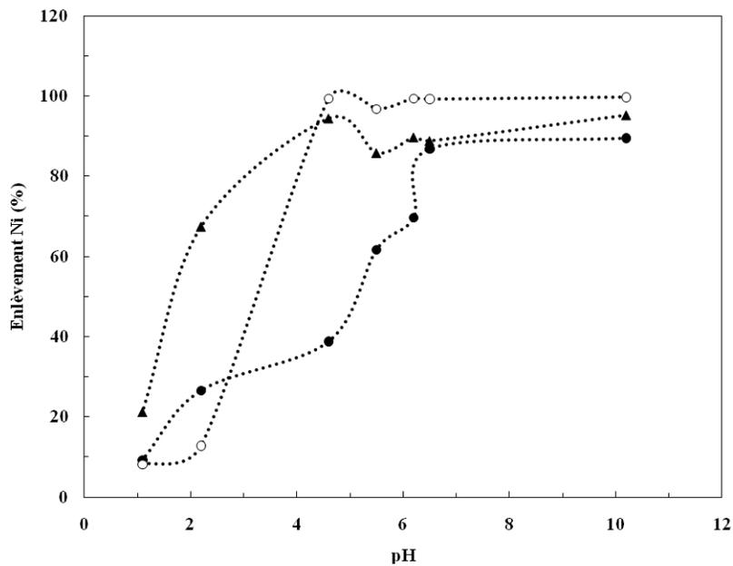
**Figure 4.4** Taux d'enlèvement du Ni, Mg et Fe du lixiviat de *A. murale* par extraction au C272 en fonction du pH. Conditions initiales:  $[\text{pH}]_i = 1.1$ ;  $[\text{Ni}]_i = 1\,145\text{ mg/L}$ ,  $[\text{Mg}]_i = 710\text{ mg/L}$ ,  $[\text{Fe}]_i = 195\text{ mg/L}$ , rapport O/A = 6.6. Symboles: (●) Ni; (○) mg; (▲) Fe
