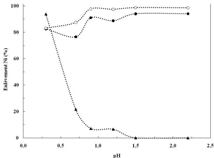
**Figure 4.5** Taux d'enlèvement du Ni et du Mg par extraction au solvant organique C272 en fonction du pH. Conditions initiales:  $[pH]_i = 1.7$ ,  $[Ni]_i = 140$  mg/L,  $[Mg]_i = 85.1$  mg/L,  $[Fe]_i = 3.31$  mg/L, Rapport O/A = 1.0. Symboles: (●) Ni; (○) Mg; (▲) Fe
