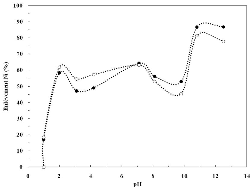
**Figure 4.3** Taux d'enlèvement du Ni et du COD en fonction du pH à partir du lixiviat global par coagulation/floculation avec le chlorure ferrique (5.0 g Fe/L). Conditions initiales:  $[pH]_i = 1.0$ ,  $[Ni]_i = 1\ 226\ mg/L$ ,  $[C]_i = 15\ 826\ mg/L$ . Symboles: (●) Ni; (○) COD
