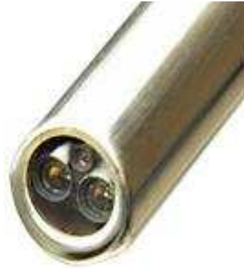
FIGURE. 2.10 – Tête d'un endoscope stéréoscopique. L'endoscope est équipé de trois canaux optiques : deux pour l'acquisition d'images avec deux caméras et le troisième (le plus petit) pour l'illumination de la scène en lumière blanche.
