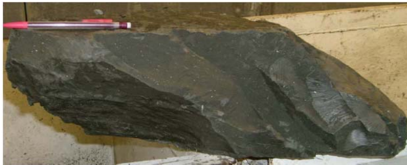
Figure 3-6 : Bloc d'argile de Boom prélevé lors de l'excavation de la galerie PRACLAY en octobre 2007
