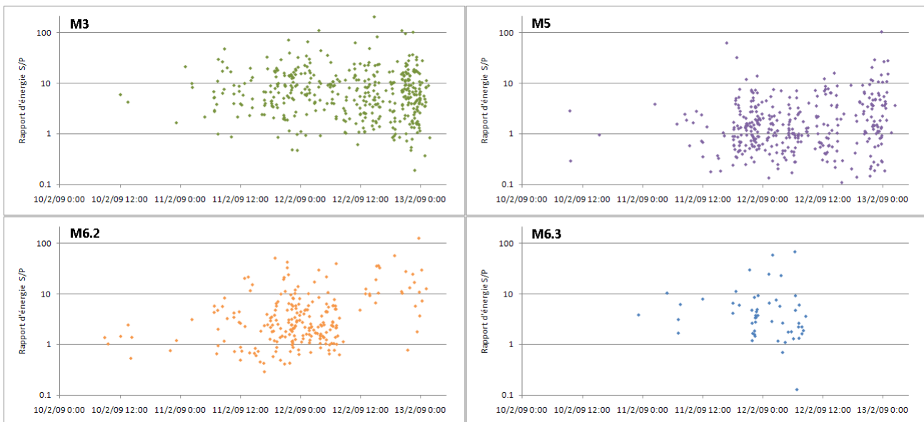
FIGURE 4.16 – Évolution des rapports en énergie au capteur des ondes P et S déterminés au niveau des sondes 3D, entre les 10 et 13/02/09. Notons que l'échelle des figures est logarithmique.
