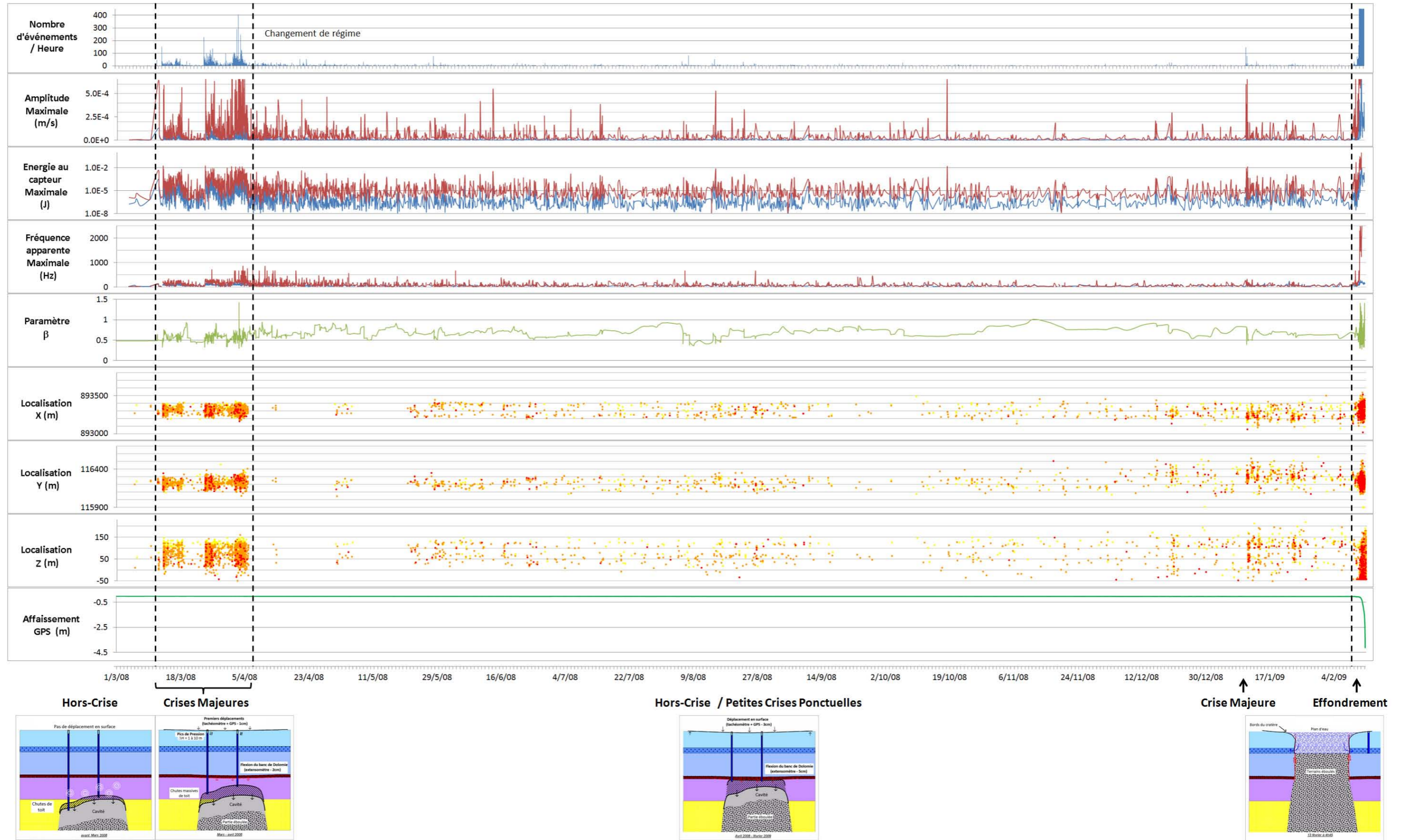
FIGURE 6.1 – Évolution de l'activité microsismique en termes de nombre d'événements, amplitude, énergie au capteur, fréquence apparente, paramètre \beta et localisation dans les directions X, Y et Z, ainsi que de l'affaissement mesuré en surface, entre les crises de Mars-Avril 2008 et l'effondrement. Des schémas des configurations successives de la cavité sont représentés.
