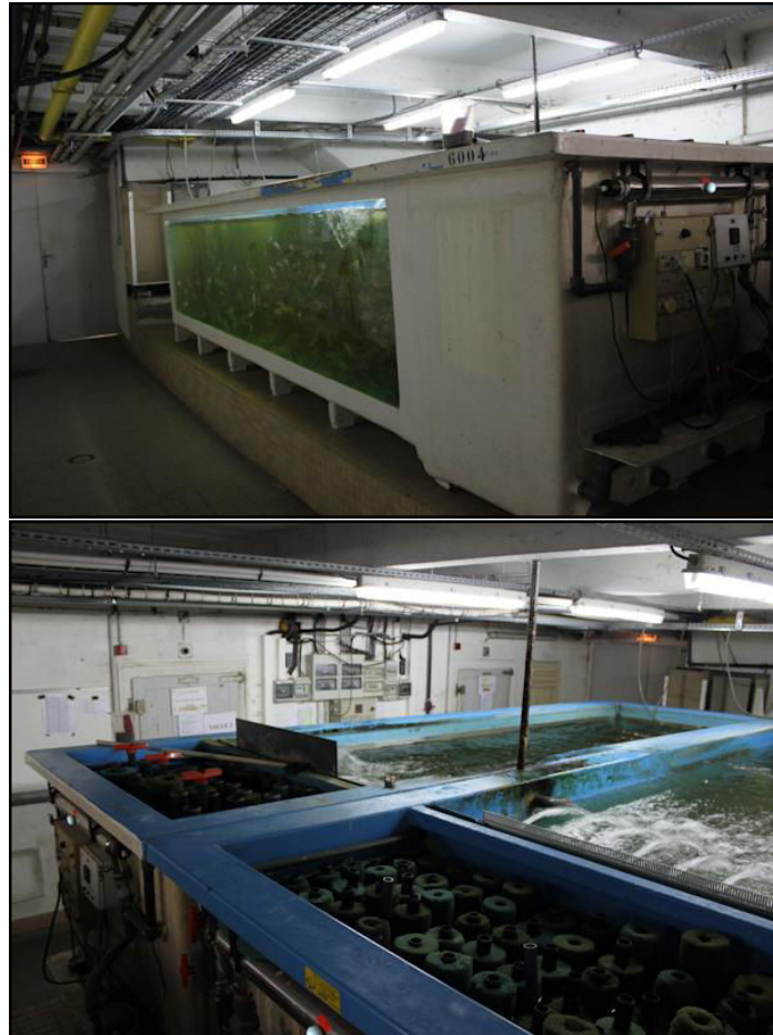
Figure 21 : Bassin de grossissement (6000 L) de la salle d'acclimatation fonctionnant en circuit fermé.
