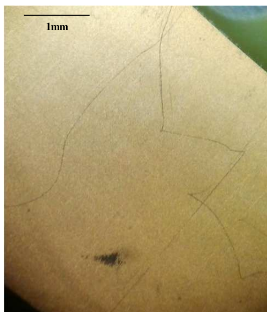
FIG. III.29 – Exemple de micro-rayures présentes à la surface des capteurs neufs
