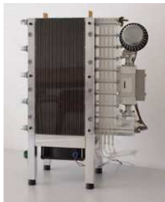
FIG. I.8 – Photo d'un stack de 2 kW conçu au LEMTA.
