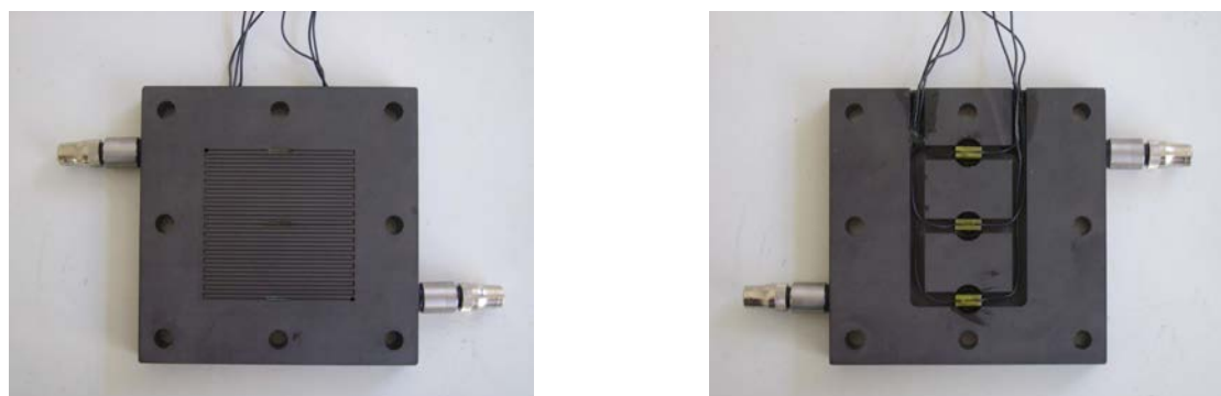
FIG. III.20 – Photos de l'avant et l'arrière de la plaque équipée des trois micro-capteurs
