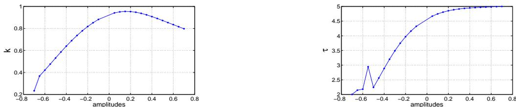
**Figure A.68** –  $k$  et  $\tau$  de  $h_{65}$  en fonction des différentes amplitudes de  $kla_5$ .
