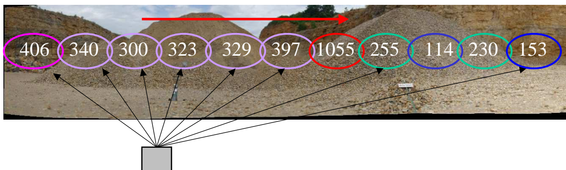
Figure 4.32 : Mesure des gaz atmosphériques par télédétection infrarouge terrestre dans la carrière de Viterne pour divers trajets optiques compris entre 10 et 30 mètres. Les concentrations en \text{CO}_2 pour chacun des points de mesures sont données en ppm.
