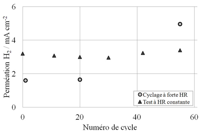
FIGURE III.7 – Densité de courant correspondant à la perméation de l'hydrogène au cours du cyclage à forte HR (62%/100%) et du test à HR constante.
