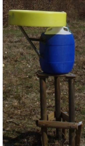
Figure 12 : Entonnoir en polyéthylène d'une surface de 0,22 m<sup>2</sup> (à gauche) et capteur hors canopée complet en clairière (à droite)
