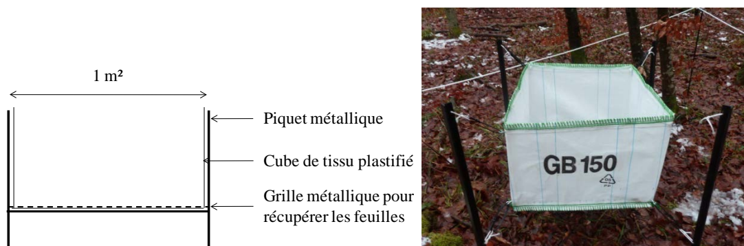
Figure 16 : Schéma et photographie du dispositif de bac à litière, composé de quatre piquets enfoncés dans le sol auquel est accroché un cube de tissu plastifié conférant une surface de dépôt de 1 m 2 , et muni d'une grille métallique dans le fond afin de faciliter la récupération des chutes de litière.
