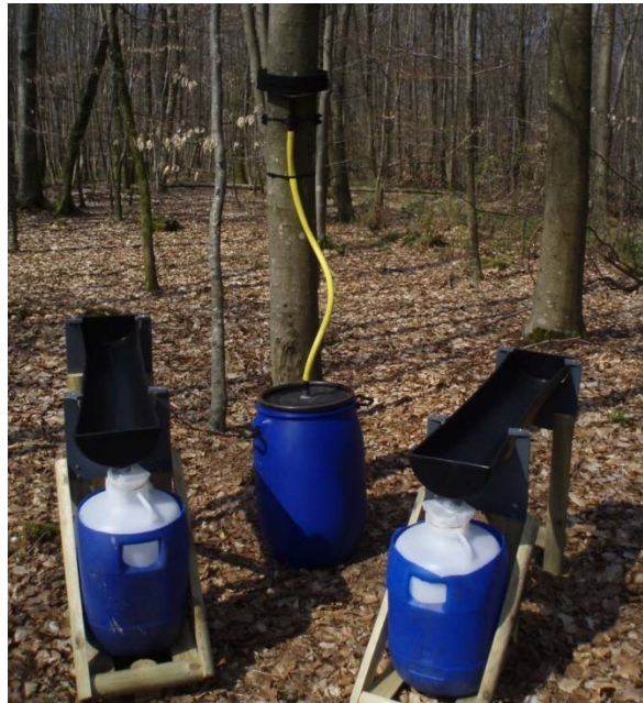
Figure 14 : collecteurs à pluviollessivat (à gauche et à droite) et ruissellement de tronc (au milieu)
