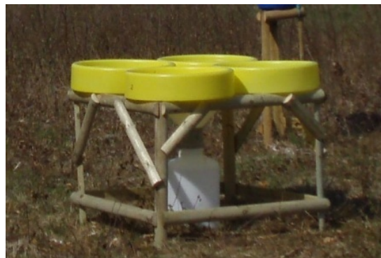
Figure 13 : Dispositif d'échantillonnage des périodes à forte charge atmosphérique entre janvier 2010 et mars 2011.
