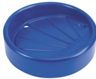
Figure 12 : Entonnoir en polyéthylène d'une surface de 0,22 m 2 (à gauche) et capteur hors canopée complet en clairière (à droite)
