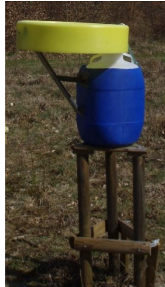
Figure 12 : Entonnoir en polyéthylène d'une surface de 0,22 m 2 (à gauche) et capteur hors canopée complet en clairière (à droite)
