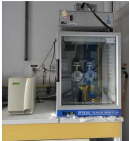
Figure 30. Appareil DVS au centre RAPSODEE.
