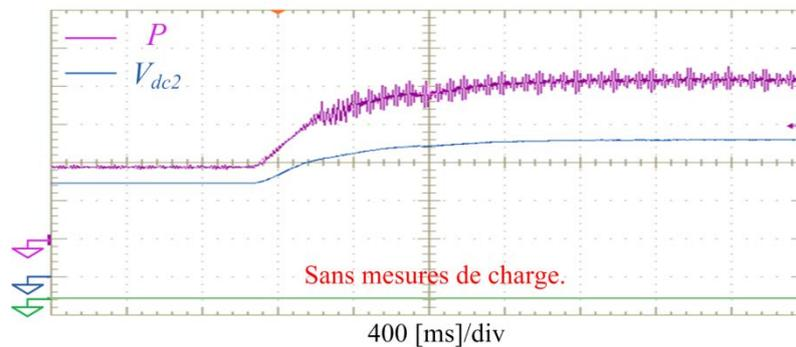
Figure 4.10. Variations de la puissance active de charge (500 W/div) et de la tension du bus dc  $V_{dc2}$  (75V/div) du redresseur commandé, sans mesures des courants de charge coté onduleur, résultat expérimental.
