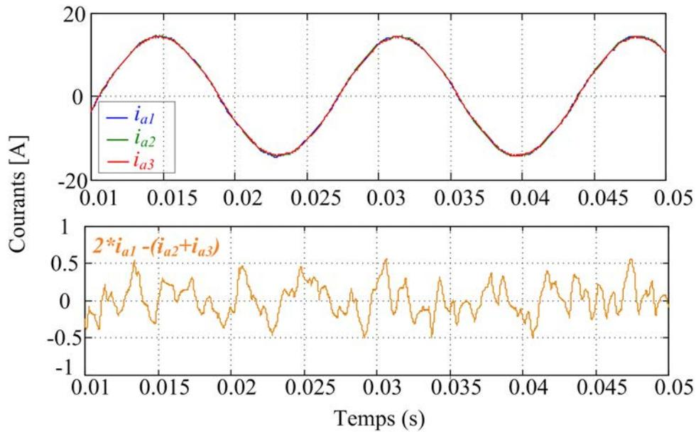
Figure 3.25. Résultats de simulation : Trois modules ( $P_{charge} = 10 kW$ ) ; Courants de ligne des phases  $a$  ainsi que leur différence.
