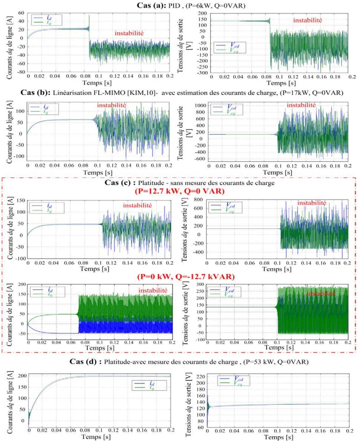
Figure 3.18. Evolution des composantes  $dq$  du courant de sortie de l'onduleur et des tensions capacitives de sortie pour différentes puissances actives de charge et pour 4 contrôles : cas(a) : P=6kW (Q=0VAR), cas (b) : P=17kW (Q=0VAR), cas (c) : (P=12.7kW, Q=0VAR) puis (P=0W, Q=-12.7kVAR), cas (d) : P=53kW (Q=0VAR).
