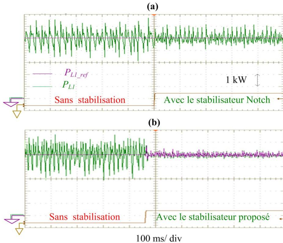
Figure 4.30. Allure de la puissance à l'entrée du redresseur lors d'une variation paramétrique ( $C = 20 \mu F$  au lieu de  $C = 40 \mu F$ ), avant et après l'emploi de méthodes de stabilisation; (a) basée sur l'utilisation du filtre Notch ; (b) basée sur le critère du cercle.
