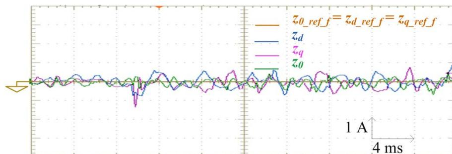
Figure 3.34. Résultats expérimentaux : Comportement des sorties plates  $z_d$ ,  $z_q$  et  $z_0$  durant une variation de puissance de charge de 0 à 3.2 kW pour une tension efficace du bus AC régulée à 110 V.
