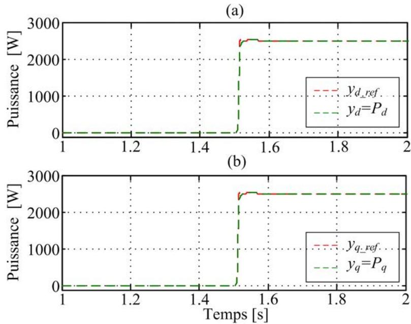
Figure 5. Résultats de simulation : Comportement de la puissance active à l'entrée du redresseur lors d'un échelon de charge allant de 0.1 kW à 5 kW à  $t=1.5s$ . ; (a)  $P_d = V_{cd} i_{Ld}$ . (b)  $P_d = V_{cq} i_{Lq}$ .
