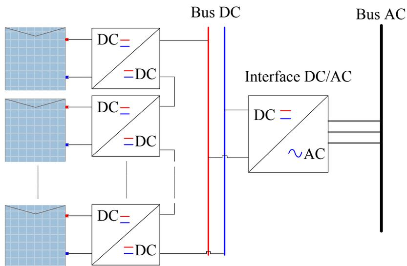
Figure 1.10. Topologie à hacheurs modulaires séries.
