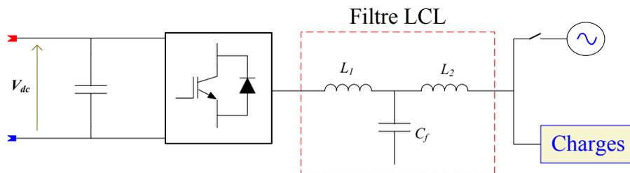
Figure 1.16. Module de conversion avec filtre LCL d'interconnexion
