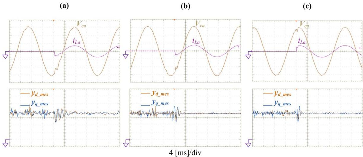
Figure 3.12. Résultats expérimentaux : Réponse à une variation rapide de la puissance de charge, tensions et courants coté charge ( $V_a$ : 50 V/div,  $i_a$ : 4 A/div) (haut); énergies électrostatiques  $dq$  ( $y_{d\_mes}$ ,  $y_{q\_mes}$ : 0.05 J/div), ( $L_f = 1$  mH,  $C_f = 20$   $\mu$ F). (a) PID , (b) Linéarisation FL-MIMO et (c) Platitude.
