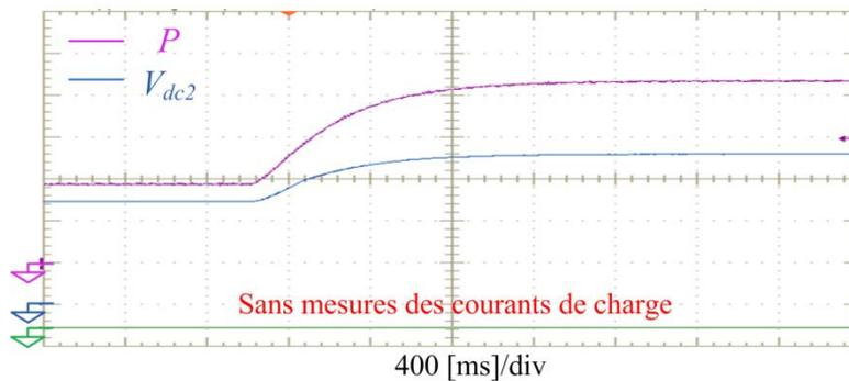
Figure 4.13. Échelon de puissance active (500 W/div) de charge et de la tension du bus dc  $V_{dc2}$ (75V/div) du redresseur, sans mesures des courants de charge coté onduleur, avec stabilisateur, résultat expérimental.
