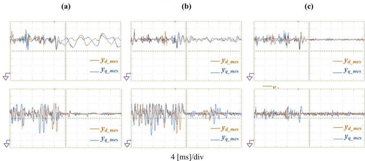
Figure 3.15. Résultats expérimentaux: Comportements des énergies électrostatiques  $y_d, y_q$  durant un échelon de charge avec :  $C_f = 50\% C_n$  ( $y_{d\_mes}, y_{q\_mes}$ : 0.02 J/div) (haut) et  $C_f = 400\% C_n$  ( $y_{d\_mes}, y_{q\_mes}$ : 0.2 J/div) (bas) . (a) PID. (b) Linéarisation FL-MIMO . (c) Platitude.
