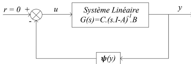
Figure 4.2. Représentation d'un système de Lur'e [KHA,01].
