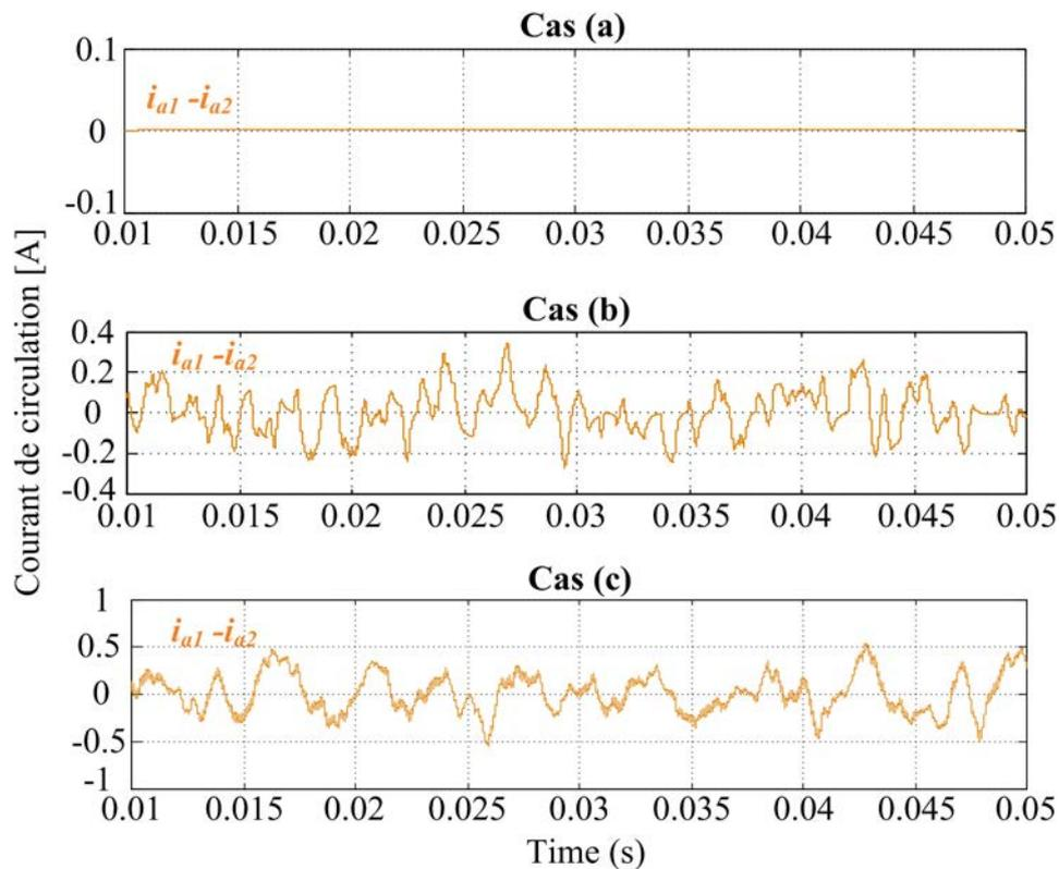
Figure 3.24. Résultats de simulation : Courants de ligne des phases  $a_1$  et  $a_2$  ainsi que leur différence pour une puissance de charge  $P_{charge} = 3.2$  kW . (a) onduleurs identiques. (b) onduleurs non identiques. (c) cas(b) avec variation paramétrique.
