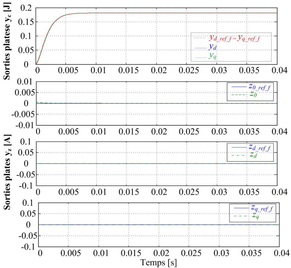
Figure 3.22. Résultats de simulation : Comportement des composantes de la sortie plate  $y$  lors d'un échelon de charge.
