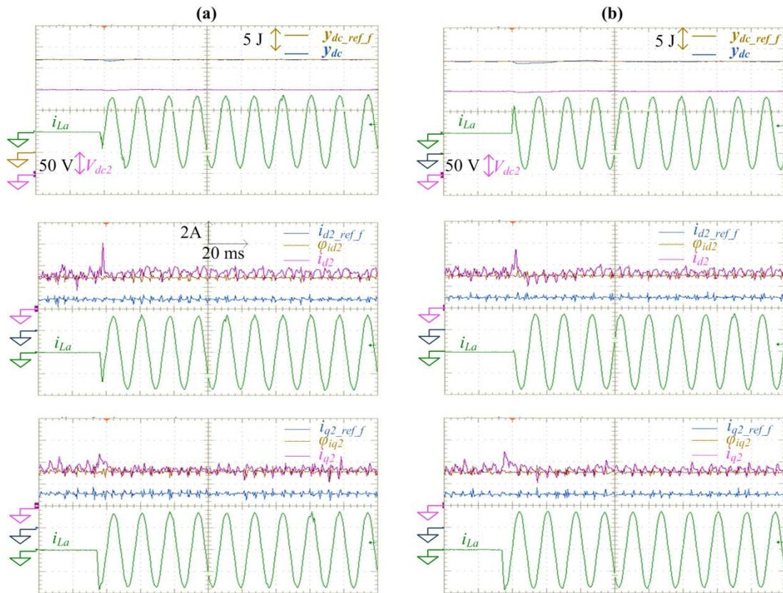
Figure 3.53. Résultats expérimentaux : Comportement des composantes liées à l'étage source suite à une variation de la valeur de  $L_2$  estimée par la commande de: (a) + 50% de sa valeur nominale ; (b) - 50% de sa valeur nominale.
