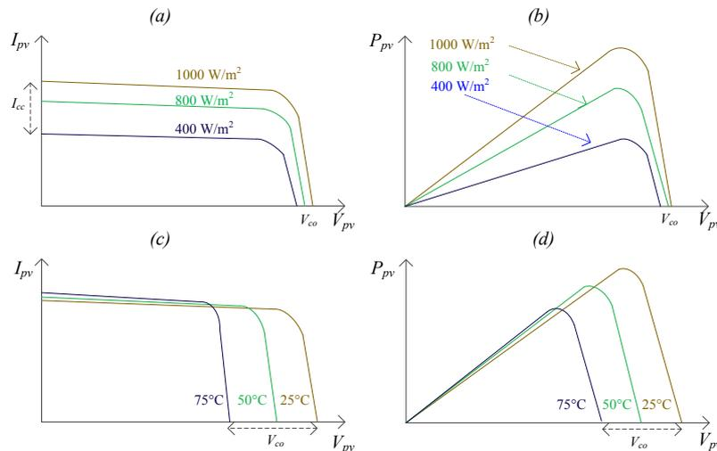
Figure 1.3. Comportement des caractéristiques  $I_{pv}(V_{pv})$  et  $P_{pv}(V_{pv})$  sous l'influence de; ((a)et (b)) : l'éclairement à température fixe, ((c) et (d)) : la température à éclairement fixe.
