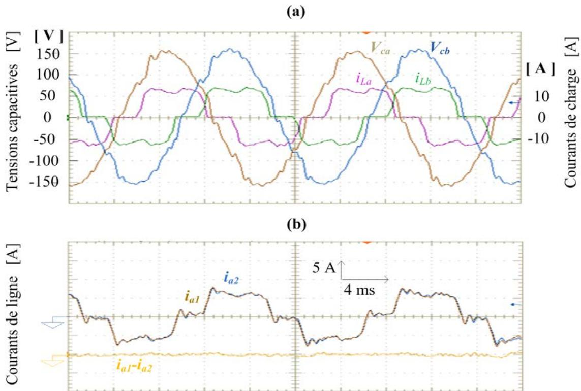
Figure 3.38. Résultats expérimentaux : Cas d'une charge non linéaire,  $P_{charge} = 3.2 kW$ . (a) Tensions et courants de charge. (b) Courants de ligne des phases  $a_1$  et  $a_2$  ainsi que leur différence.
