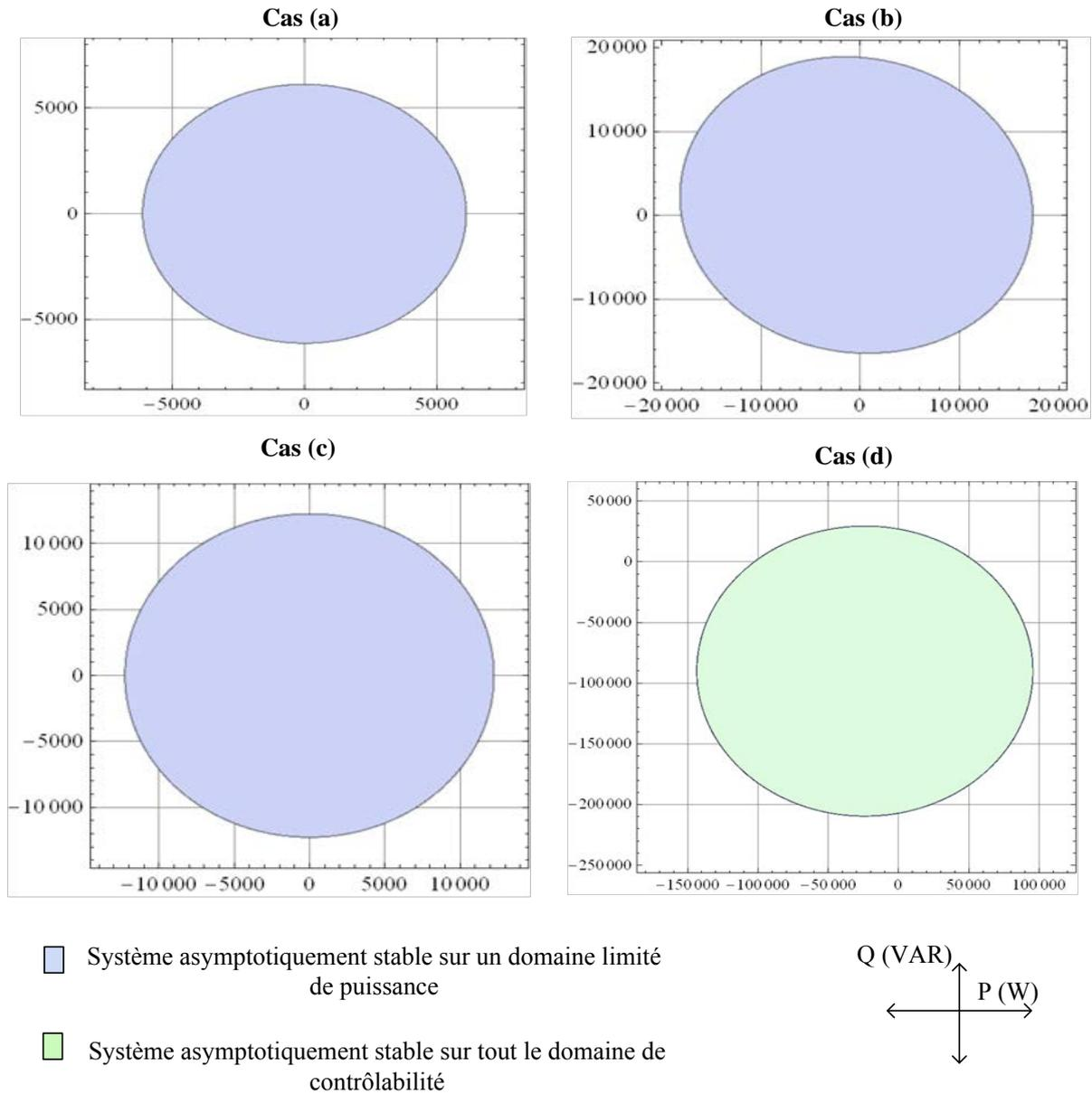
Figure 4.5. Ensemble des points où la stabilité locale asymptotique est garantie, pour quatre types de contrôleurs, **cas(a)** PID, **cas (b)** FL-MIMO, **cas (c)** FBC sans capteur de courant de charge, **cas (d)** FBC avec capteurs de courant de charge.
