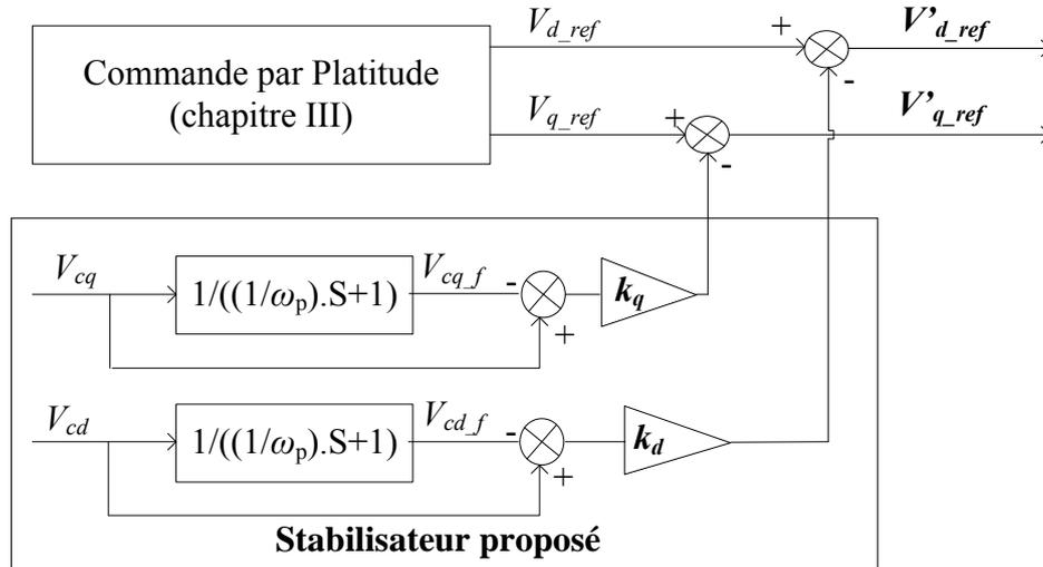
Figure 4.6. Structure du stabilisateur proposé.
