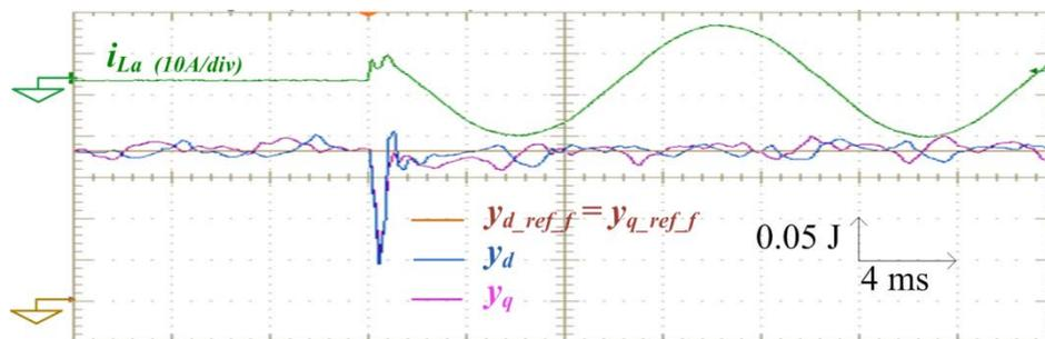
Figure 3.33. Résultats expérimentaux : Comportement des sorties plates  $y_d$  et  $y_q$  durant une variation de puissance de charge de 0 à 3.2 kW pour une tension efficace du bus AC régulée à 110 V.
