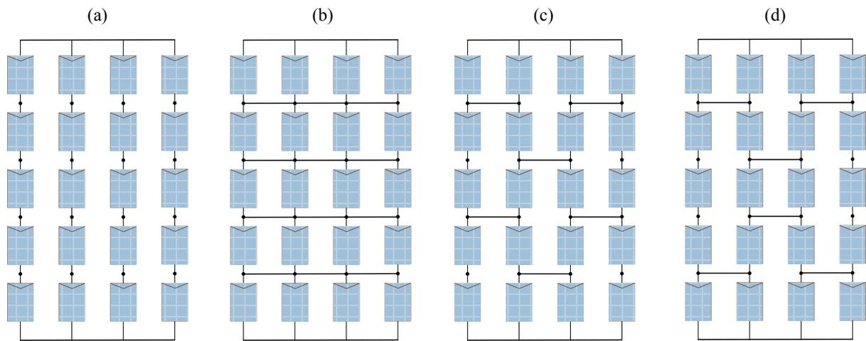
Figure 1.7. Schéma de câblage en ; (a) série-parallèle (SP), (b) totalement interconnectée (TCT), (c) pont (BL-bridge-linked), (d) cuillère à mile (HC-honey comb).
