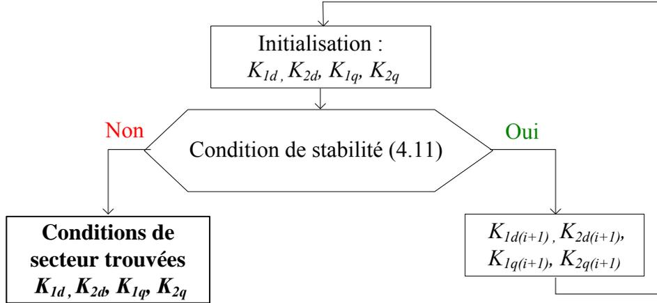
Figure 4.22. Algorithme d'optimisation des conditions de secteur.
