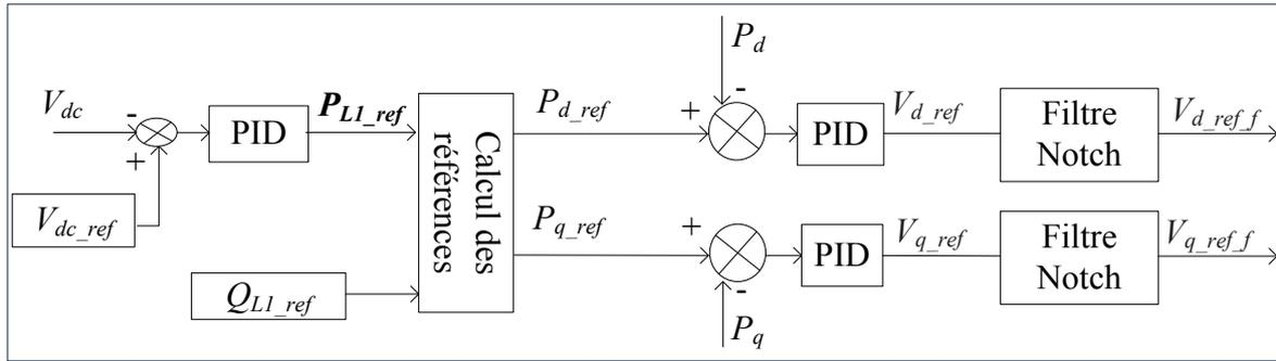
Figure 4.19. Principe de la stabilisation par filtre Notch.
