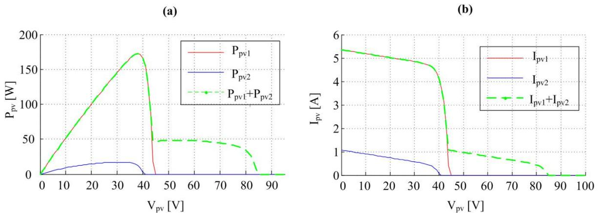
Figure 2.3. Caractéristiques statiques P-V et I-V résultant de l'association de deux panneaux soumis à des conditions d'éclairage et de température différentes (Cond 1:  $1000\text{ W/m}^2$ ,  $25^\circ\text{C}$  ; Cond 2:  $200\text{ W/m}^2$ ,  $22^\circ\text{C}$ ).
