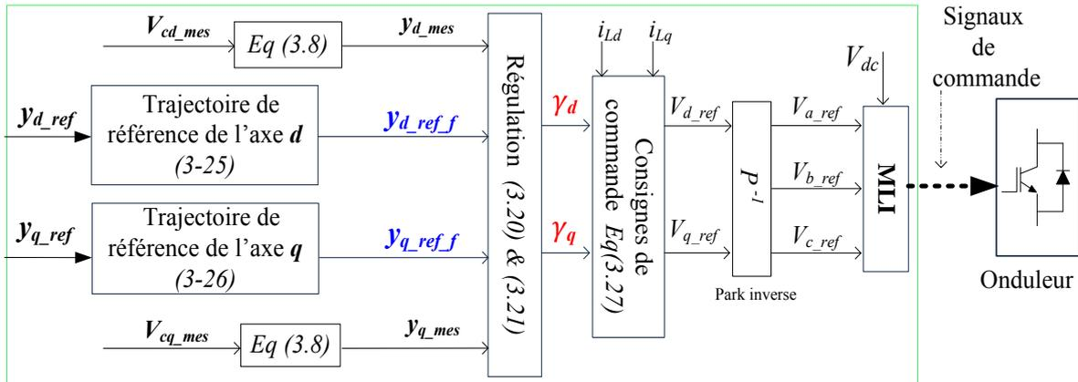
Figure 3.4. Diagramme fonctionnel de la commande proposée.
