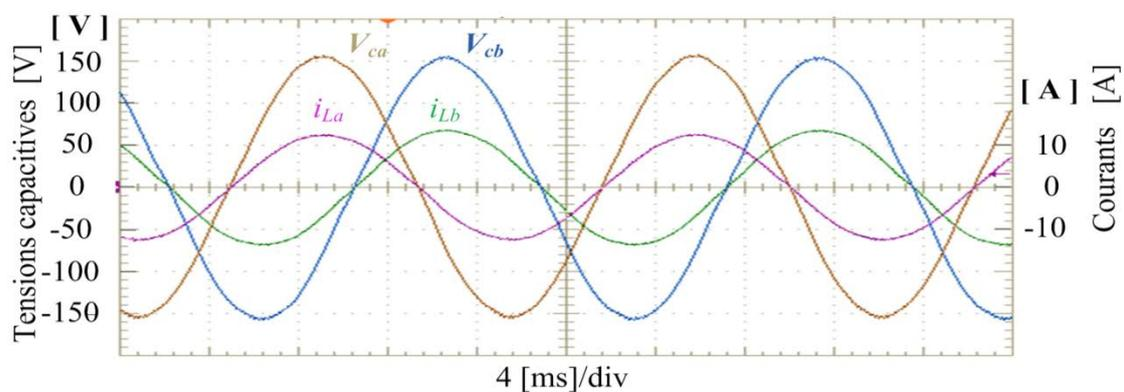
Figure 3.31. Résultats expérimentaux : Tensions capacitives et courants de charge en régime permanent,  $P_{charge} = 3.2 \text{ kW}$  avec une tension efficace du bus AC régulée à 110 V.
