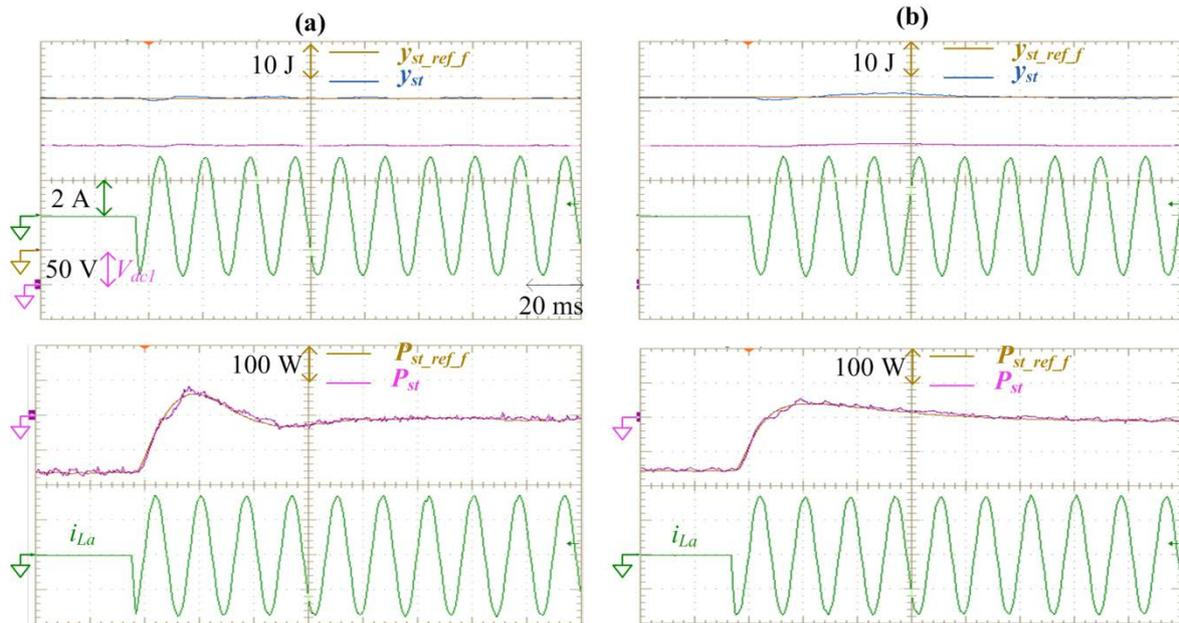
Figure 3.55. Résultats expérimentaux : Comportement des composantes associées au hacheur de stockage suite à une variation de la valeur de  $C_{dc1}$  estimée par la commande de: (a) + 50% de sa valeur nominale ; (b) – 50% de sa valeur nominale.
