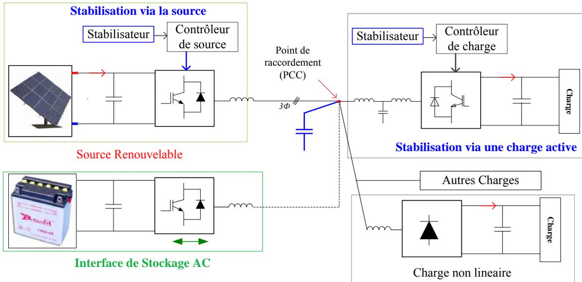
Figure 4.1. Options de stabilisation d'un micro-réseau autonome.
