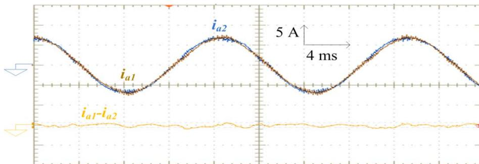
Figure 3.30. Résultats expérimentaux : Courants de ligne des phases  $a_1$  et  $a_2$  ainsi que leur différence en régime permanent, charge résistive équilibrée ( $P_{charge} = 3.2 \text{ kW}$ ).
