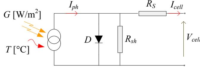
Figure 2.1. Schéma électrique équivalent d'une cellule photovoltaïque.
