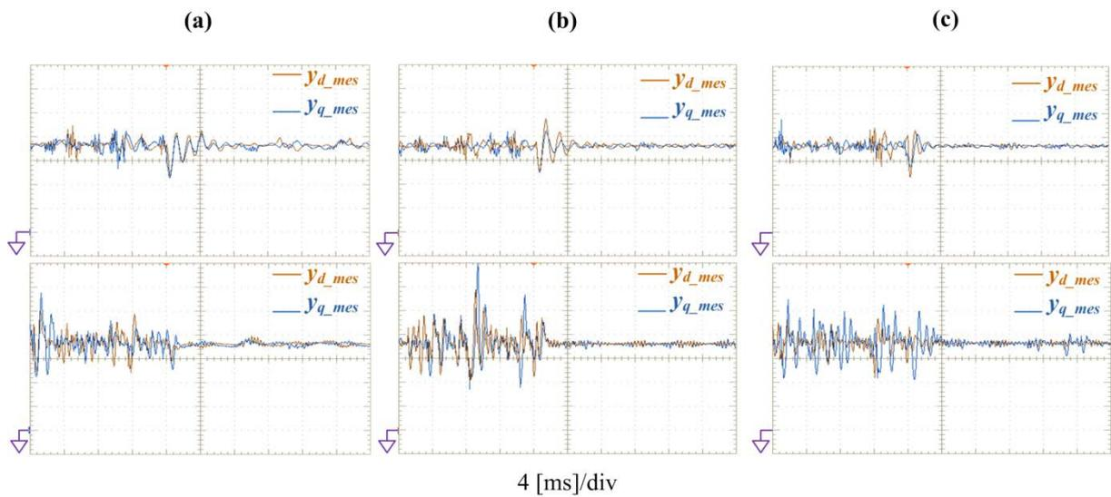
Figure 3.14. Résultats expérimentaux: Comportements des énergies électrostatiques  $y_d, y_q$  (0.05 J/div) après un échelon de charge avec :  $L_f = 50\% L_n$  (haut) et  $L_f = 250\% L_n$  (bas) . (a) PID. (b) Linéarisation FL-MIMO. (c) Platitude.
