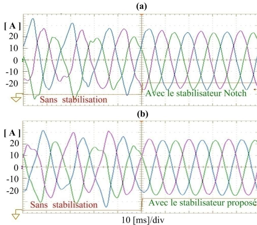
Figure 4.29. Allure de courants à l'entrée du redresseur avant et après l'utilisation des méthodes de stabilisation ; (a) basée sur l'utilisation du filtre Notch ; (b) basée sur le critère du cercle.
