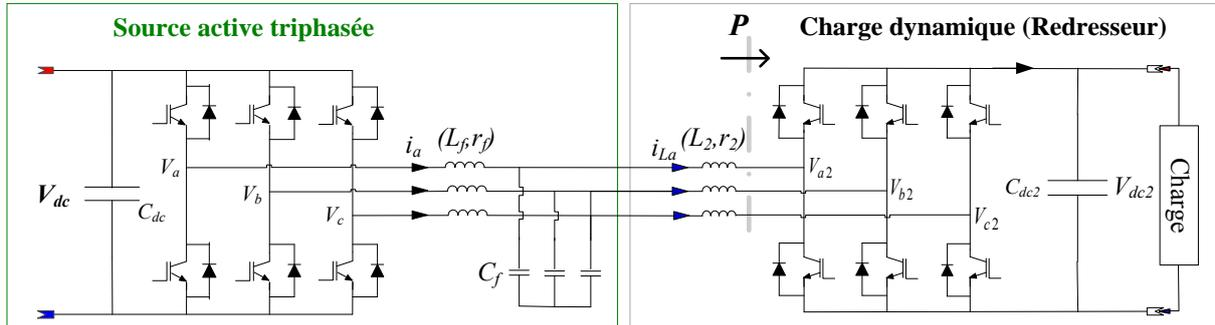
Figure 4.4. Source active triphasée alimentant un redresseur commandé.
