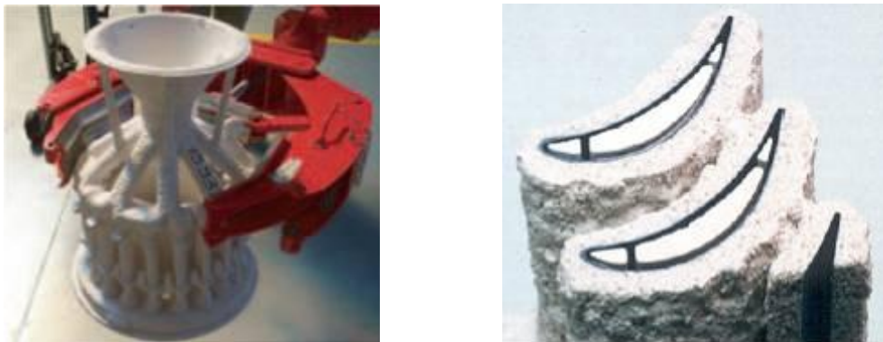
Figure 6 : Grappe composée de n modèles (à gauche) ; découpe de modèles contenant des noyaux céramiques après étape de décirage (à droite) [8].
