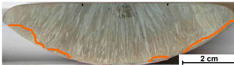
**Figure 32 : Estimation du puits liquide.**
