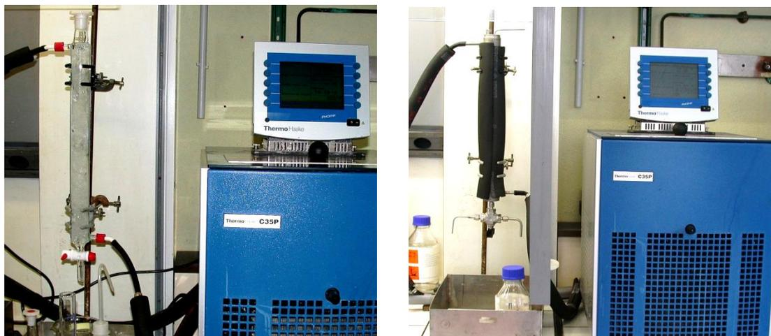
Figure 2-18 : Dispositifs expérimentaux : cristailliseurs connectés à un thermocryostat
