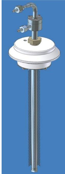
Figure 5-11 : Tube de cristallisation à ailettes
