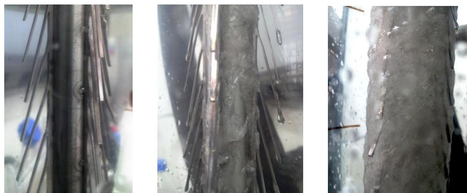
Figure 4-13 : Couche cristalline produite dans le dispositif de cristallisation avec ailettes – gauche : tube dépourvu de couche cristalline ; milieu : tube après la formation de la couche d'amorçage ; droite : tube après l'étape de cristallisation
