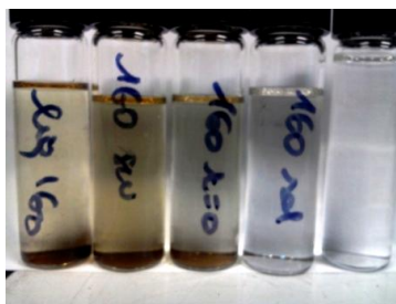
Figure 4-27 : Photographie des différentes fractions issues de la purification d'un mélange complexe - (de gauche à droite) phase liquide impure ; liquide issu du ressuage ; mélange initial à purifier ; phase cristalline ; eau (échantillon témoin)
