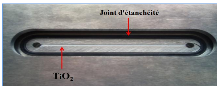
Figure II. 7 : Microcanal du Rinox imprégné de catalyseur.
