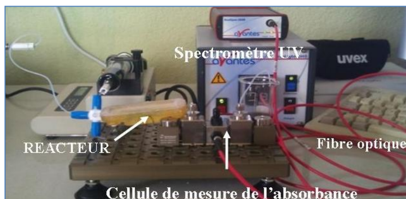
Figure II. 16 : Dispositif de détermination de temps de séjour dans le microréacteur à l'aide d'un traceur par spectroscopie.
