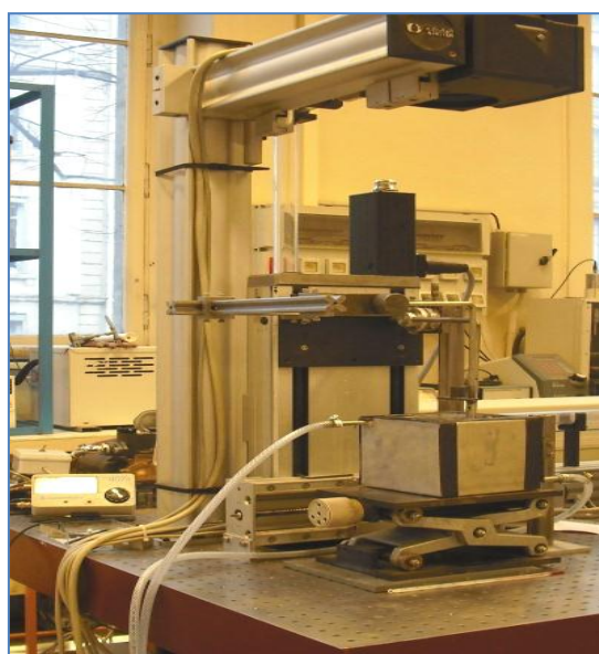
Figure II. 2 : Vue d'ensemble de la machine de stéréolithographie du laboratoire.
