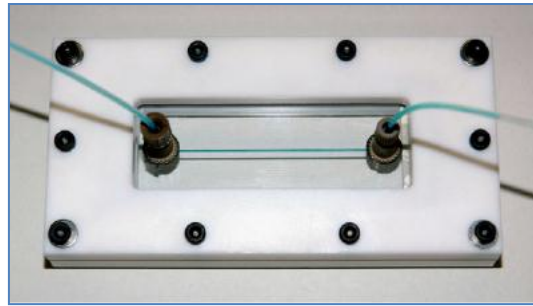
Figure I.11 : Microréacteur photocatalytique monocanal droit (Matsushita et al. , 2008).
