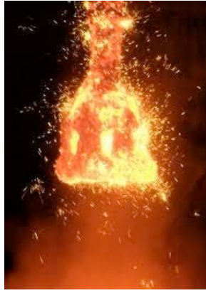
Figure 2-2 : Tête d'immersion pour introduction de Mg (après traitement) (1cm photo = 15cm réel)
