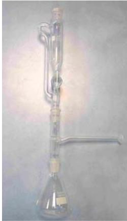
Erlenmeyer connecté à l'ampoule à décanter
