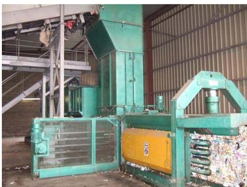
*Figure 46 : Vue d'une presse de mise en balle de déchets ménagers en aluminium (photo INERIS)*
