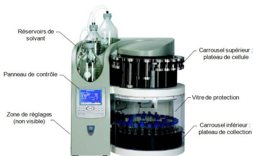
Figure III-8 : Photographie de l'extracteur automatique sous pression (DIONEX© ASE 350).
