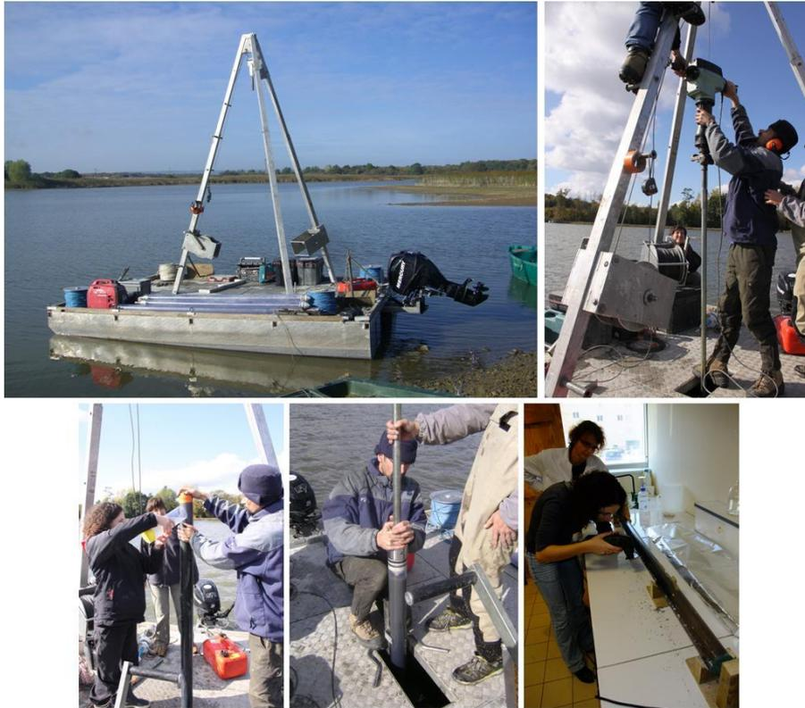
Figure III-2 : Photographies de la plate forme de carottage UWITEC© (EDYTEM, Université de Chambéry), de la mission d'échantillonnage MIRABELL et de l'ouverture des carottes.
