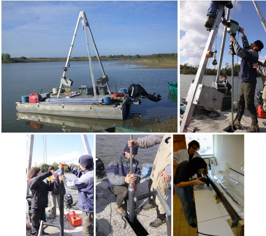
Figure III-2 : Photographies de la plate forme de carottage UWITEC© (EDYTEM, Université de Chambéry), de la mission d'échantillonnage MIRABELL et de l'ouverture des carottes.
