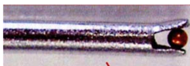
Figure 45 : Bille de cuivre sur la tige lui servant de support dans la cellule millifluidique
