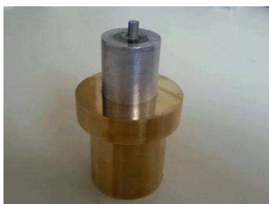
Figure 2.29 : Préparation de la partie centrale avant orientation au Laue.
