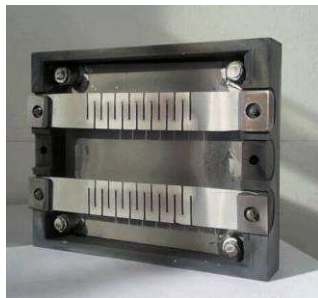
Figure 2.24 : Capot avec les deux résistors après utilisation
