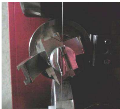
Figure 2.32 : Découpe à la scie à fil après orientation Laue.
