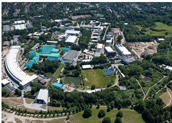
Figure 2.4 : Doris III, anneau de 289 mètres de circonférence et 31 lignes de lumière
