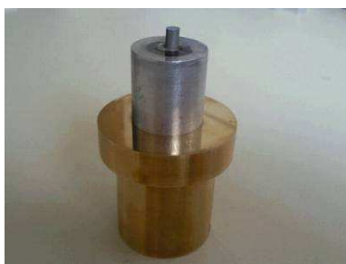
Figure 2.29 : Préparation de la partie centrale avant orientation au Laue.
