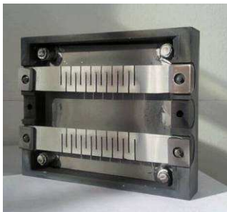
Figure 2.24 : Capot avec les deux résistors après utilisation
