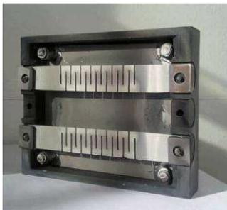
Figure 2.24 : Capot avec les deux résistors après utilisation
