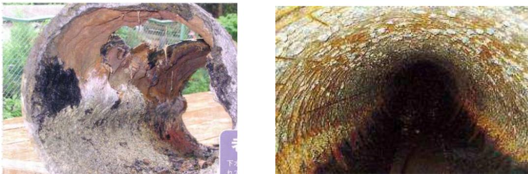
**Figure 2 :** Images montrant l'impact du biofilm sur les canalisations du réseau d'assainissement.
