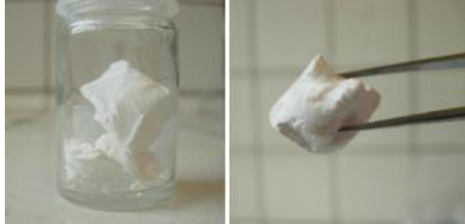
Figure I.8 : Aérogel issu de l'organogel à 1% en masse dans le toluène.
