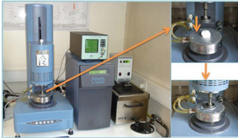
Figure 9. Rhéomètre à contrainte imposée AR2000 (TA Instruments)
