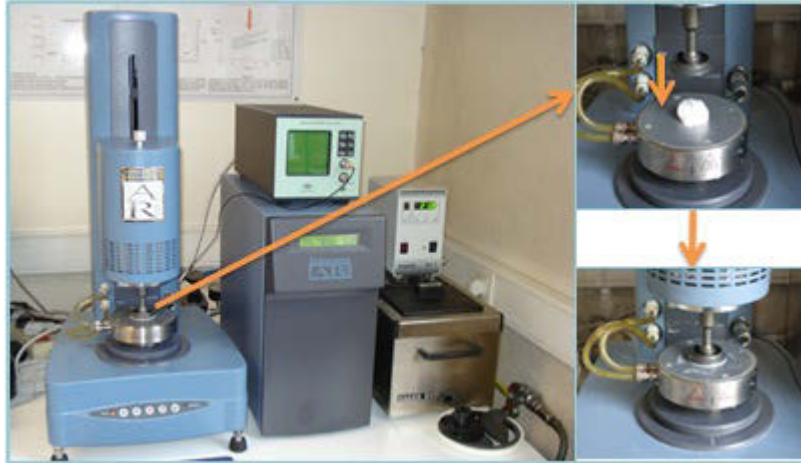
Figure 9. Rhéomètre à contrainte imposée AR2000 (TA Instruments)
