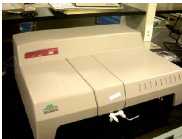
Figure 6. Appareil de mesure DLS de type HPPS-ET (Malvern)
