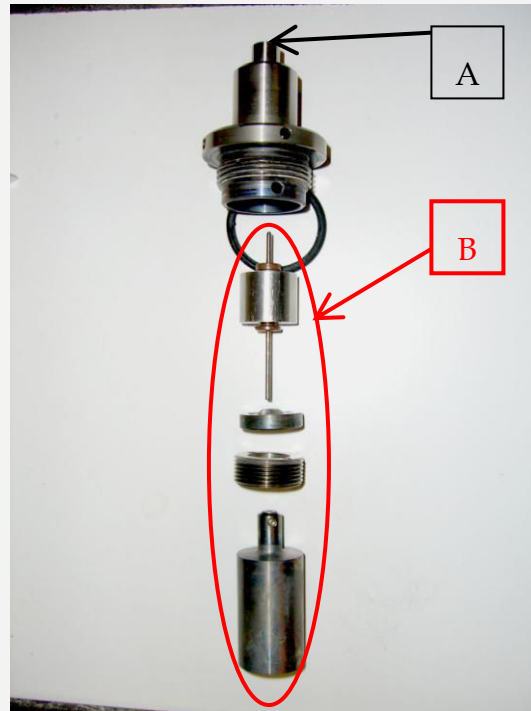
Photographie 1 : Géométrie de la cellule sous pression + bouchon de celle-ci. Point A = point d'injection de l'eau par le bouchon. Ensemble B = volume à calculer par Archimède.
