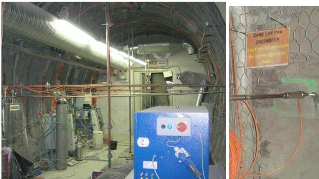
Figure 44 : Cannes de convergence dans la galerie SDZ, et rotules en paroi (d'après Cruchaudet et Noiret, 2011)
