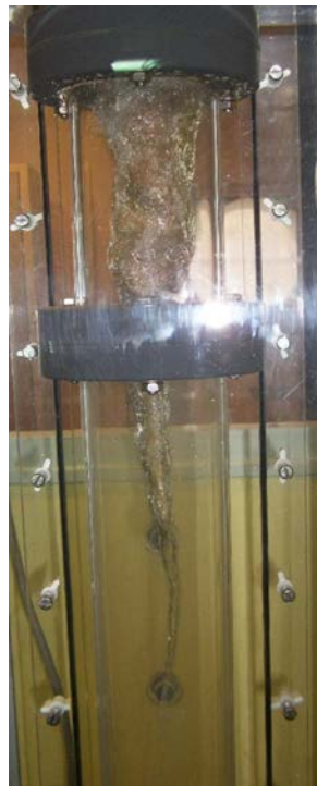
(c) Vortex fort , Q_l = 8,55 \text{ m}^3/\text{h} ( V_{s,c,l} = 0,584 \text{ m/s} ), \dot{m}_g = 15 \text{ m}^3/\text{h} ( V_{s,c,l} = 0,853 \text{ m/s} ). La bride supérieure se situe à 22 cm environ au-dessous du niveau de l'entrée. La distance entre les deux brides sur la photo est de 15 cm.
