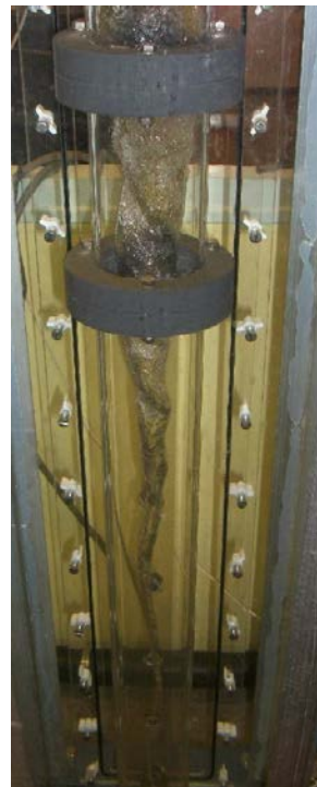
(c) Vortex fort , Q_l = 8,55 \text{ m}^3/\text{h} ( V_{s,c,l} = 0,584 \text{ m/s} ), \dot{m}_g = 15 \text{ m}^3/\text{h} ( V_{s,c,l} = 0,853 \text{ m/s} ). La bride supérieure se situe à 22 cm environ au-dessous du niveau de l'entrée. La distance entre les deux brides sur la photo est de 15 cm.
