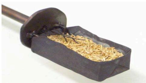
Figure II-10 : Photographie de la tige coulissante d'insertion constituée de la nacelle (échelle : 1/1.8)
