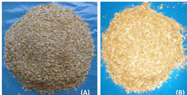
Figure II-1 : Photographies de sciure de hêtre (A) et de paille de blé tamisée (B) (échelle: 1/7)
