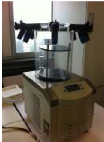
Figure II-10 : Lyophilisateur Christ Alpha 1-2 LD utilisé au LIMOS
