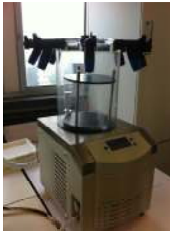
Figure II-10 : Lyophilisateur Christ Alpha 1-2 LD utilisé au LIMOS
