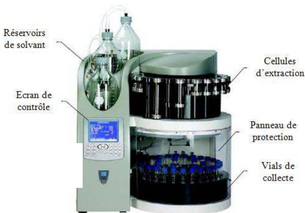
Figure II-13 : ASE Dionex 350 utilisé au LRGP
