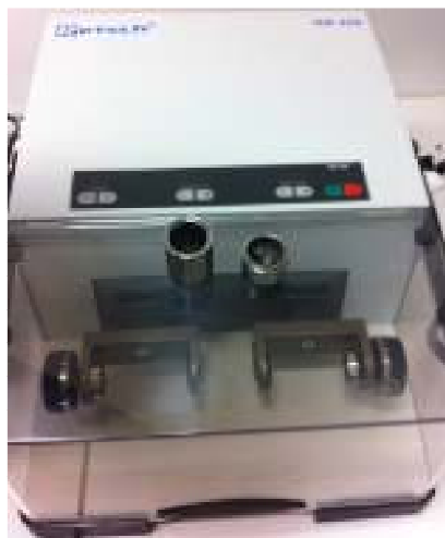
Figure II-12 : Broyeur à billes Retsch MM200 utilisé au LIMOS
