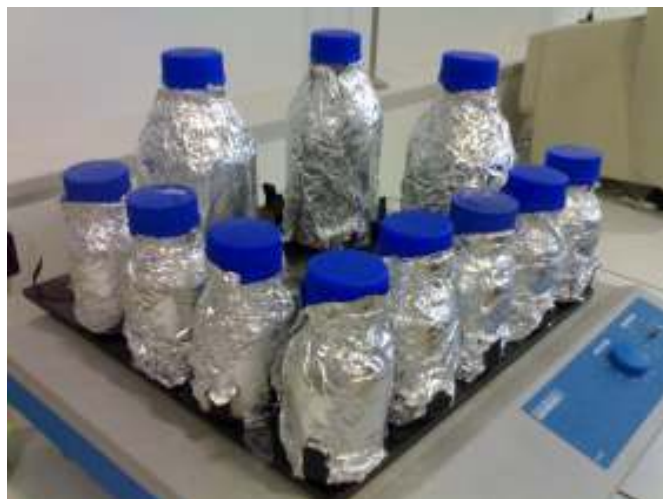
Figure III-1 : Expériences en réacteurs fermés agités
