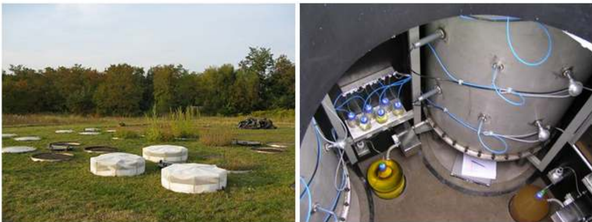
Figure II-6 : Vue d'extérieur et d'intérieur des colonnes lysimétriques du GISFI
