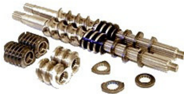
Figure 2.10 Éléments de vis et arbres cannelés de l'extrudeuse bivis
