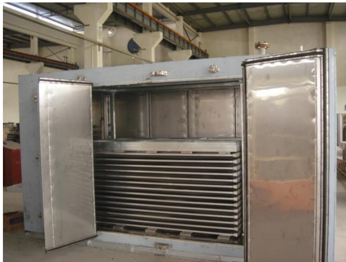
Figure 7 : Photographie d'un congélateur à plaques
