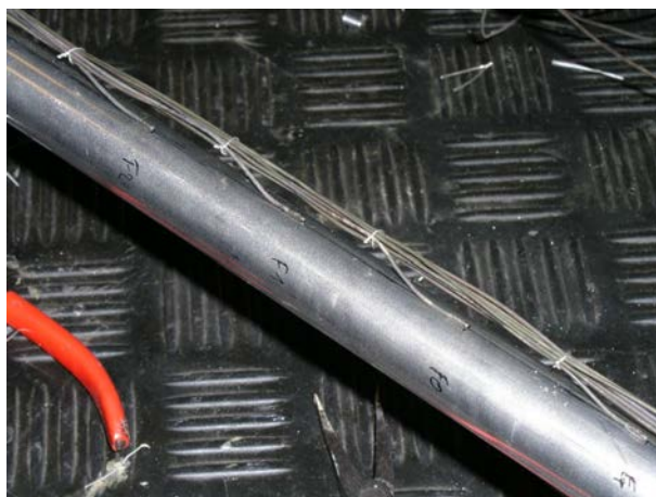
FIG. 4.5 – Thermocouples fixés sur la section d'essai
