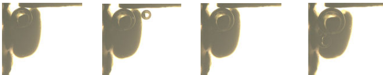
Fig. III. 54. Phénomène de coalescence avec un intervalle de temps de cinq secondes.
