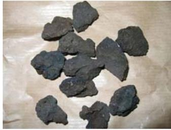
**figure 4.9 : Aspect du sulfure de manganèse utilisé pour le marquage des puits pendant la fusion B**
