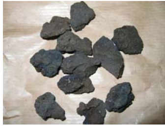
figure 4.9 : Aspect du sulfure de manganèse utilisé pour le marquage des puits pendant la fusion B
