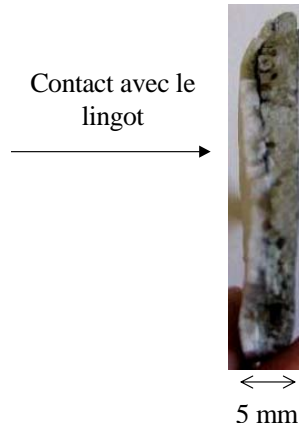
figure 4.19 : Echantillon de peau de laitier solide prélevé à 0,99 m de la tête du lingot
