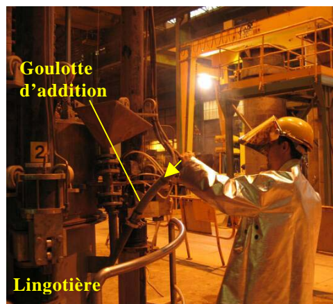
figure 4.10 : Introduction du sulfure de manganèse par l'intermédiaire d'une goulotte d'addition lors de la fusion B
