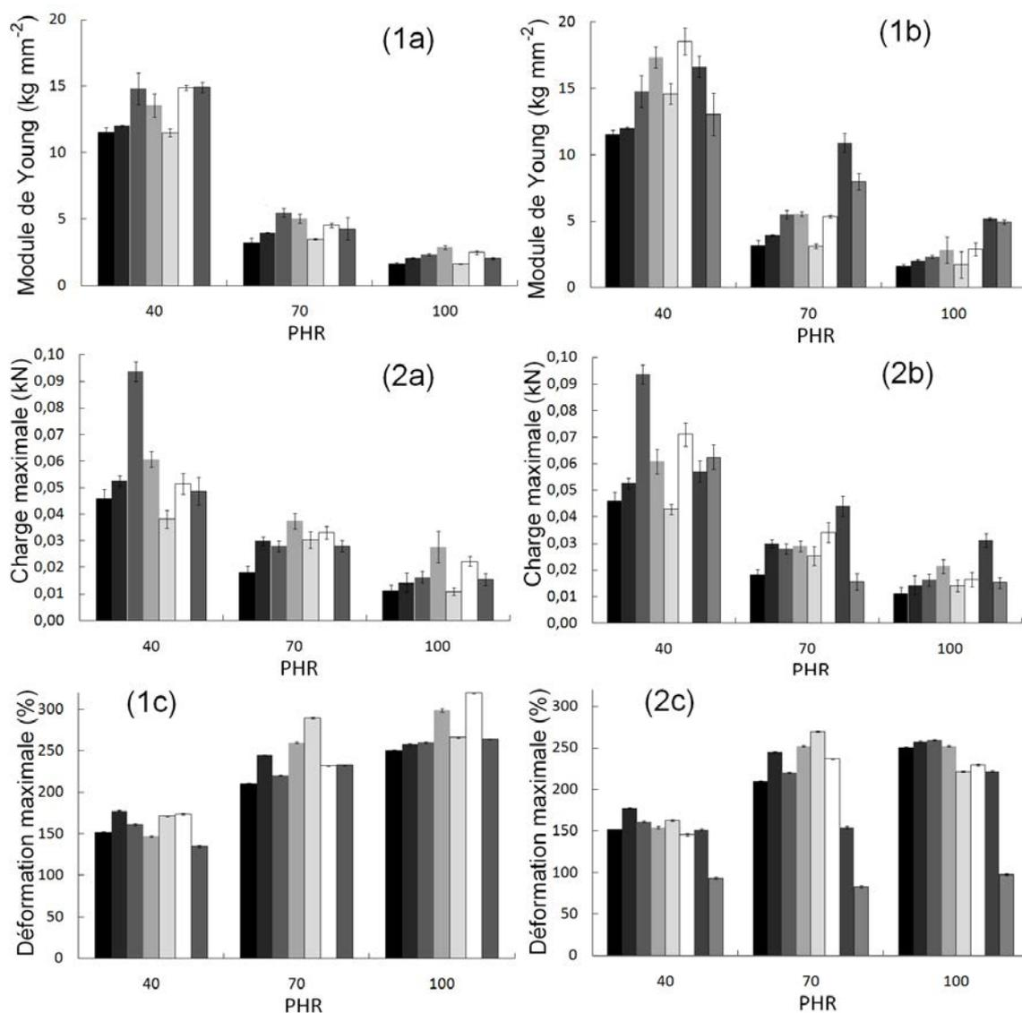
1. Module de Young, 2. charge maximale, 3. déformation maximale
