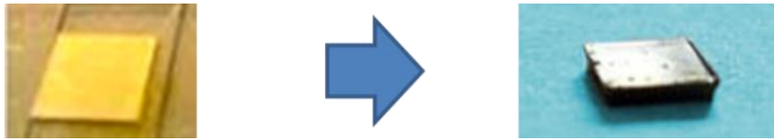
Figure I-6 À gauche, un substrat HPHT 5x5 mm 2 poli. Sa couleur jaune provient de la présence d'impuretés d'azote. À droite, le monocristal obtenu par homoépitaxie après dépôt CVD. Ce dernier est transparent. Le substrat de départ a été ici retiré par traitement mécanique (CEA-LIST) [Sarrieu07].
