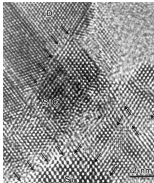
Figure I-25 Diamant en épitaxie sur du carbure de silicium cubique lui-même en épitaxie sur silicium [Wittorf00]
