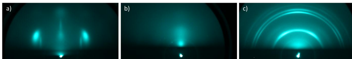
Figure IV-2 Clichés RHEED obtenus après un prétraitement d'une heure à 15 % de méthane pour trois températures de surface : a) 500°C, b) à 880°C et c) 940°C. Le faisceau d'électrons est aligné selon la direction \langle 110 \rangle du substrat.
