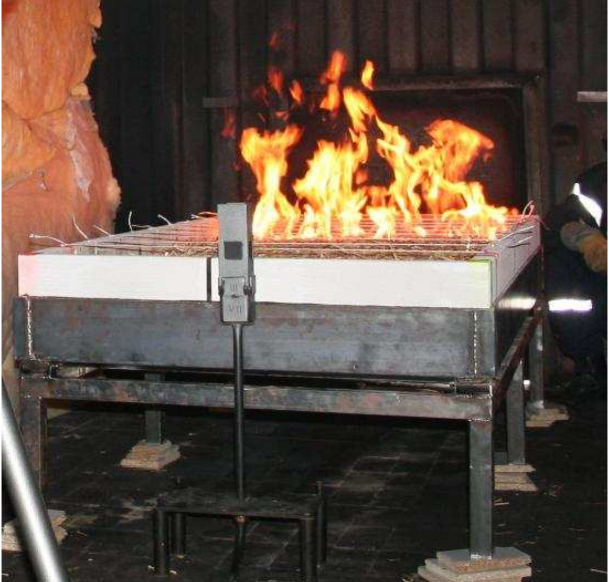
Figure 2.10. Positionnement du capteur thermique.
