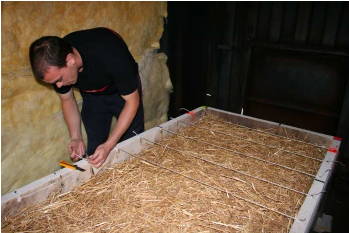
Figure 2.9. Placement des fils de nylon.
