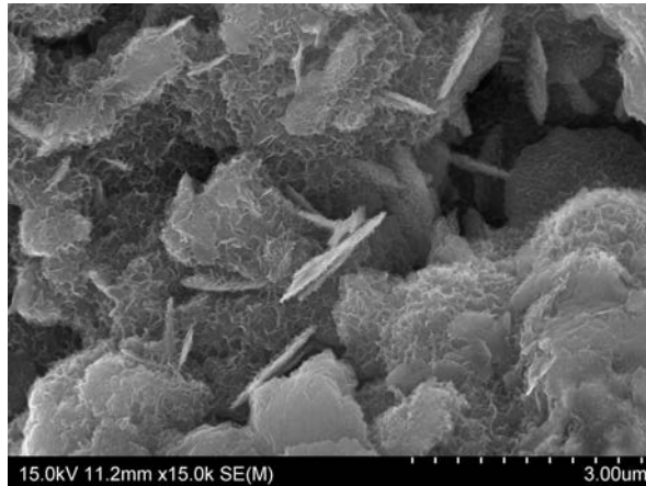
Figure 117. Micrographie MEB de la fraction grossière de SCO_x +quartz (1 m-Fe) montrant des particules en alvéoles.
