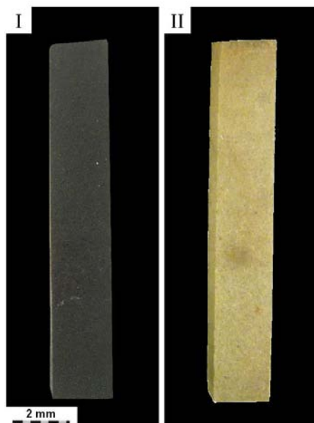
Figure 55 : Echantillon solide de la couverture avant et après expérimentation sous atmosphère de CO 2 .
