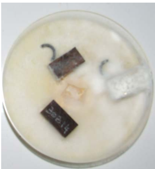
(c) Attaque de Coriolus versicolor sur les résines phénol formaldéhyde
