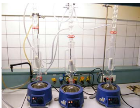
FIGURE 35 – Montages pour l'extraction au soxhlet
