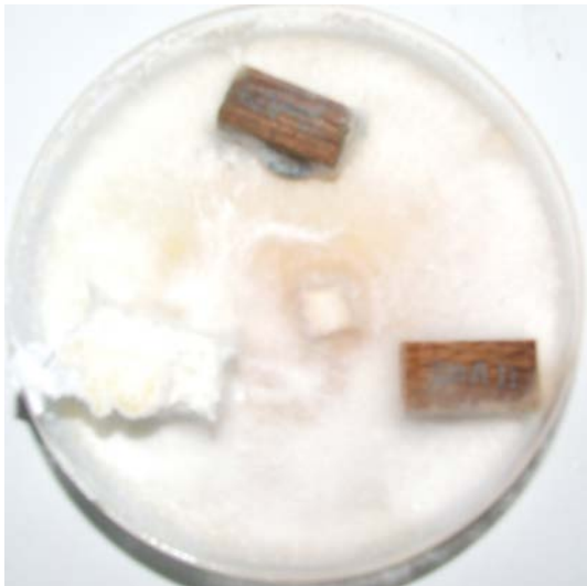
(a) Attaque de Poria placenta sur les résines phénol formaldéhyde
