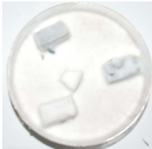
(b) Attaque de Poria placenta sur la résine phénol/eau/éthanol
