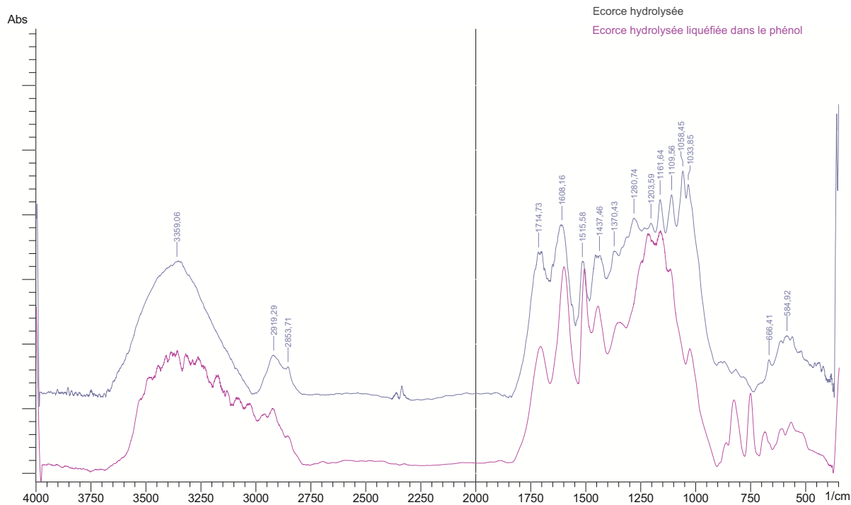
FIGURE 73 – Comparaison des spectres FTIR des écorces hydrolysées et des résidus obtenus lors de la liquéfaction des écorces dans le phénol sous reflux
