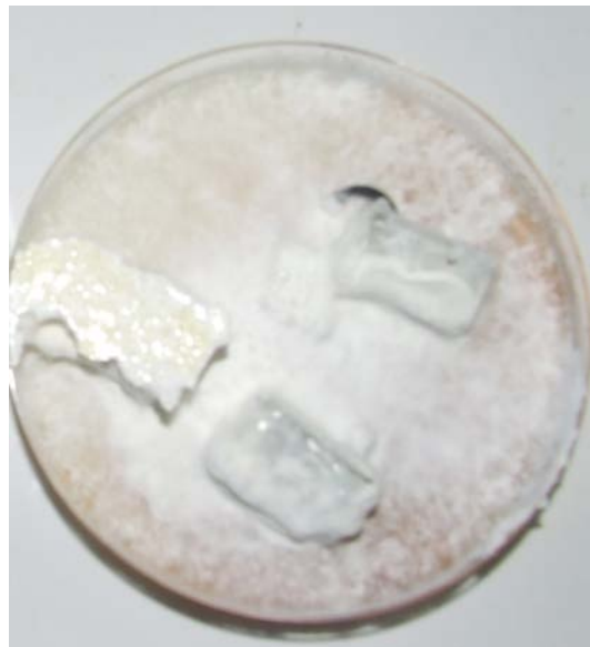
(d) Attaque de Coriolus versicolor sur la résine phénol/eau/éthanol
